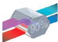
Récupérateur à plaques haut rendement avec bypass intégré
