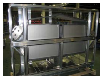
échangeur à plaques à contre-courant monté verticalement
