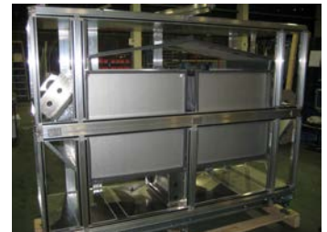
tegenstroomplatenwisselaar boven elkaar gemonteerd
