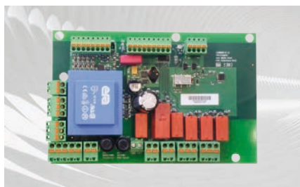
БЛОК УПРАВЛЕНИЯ В КОРПУСЕ УСТАНОВКИ
